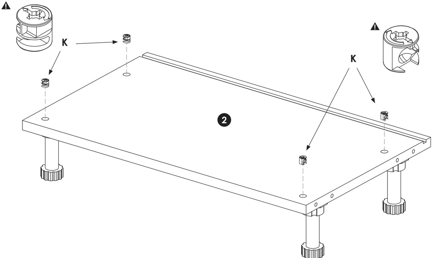
⚠ La flèche des excentriques est orientée vers l'extérieur de la tablette.
