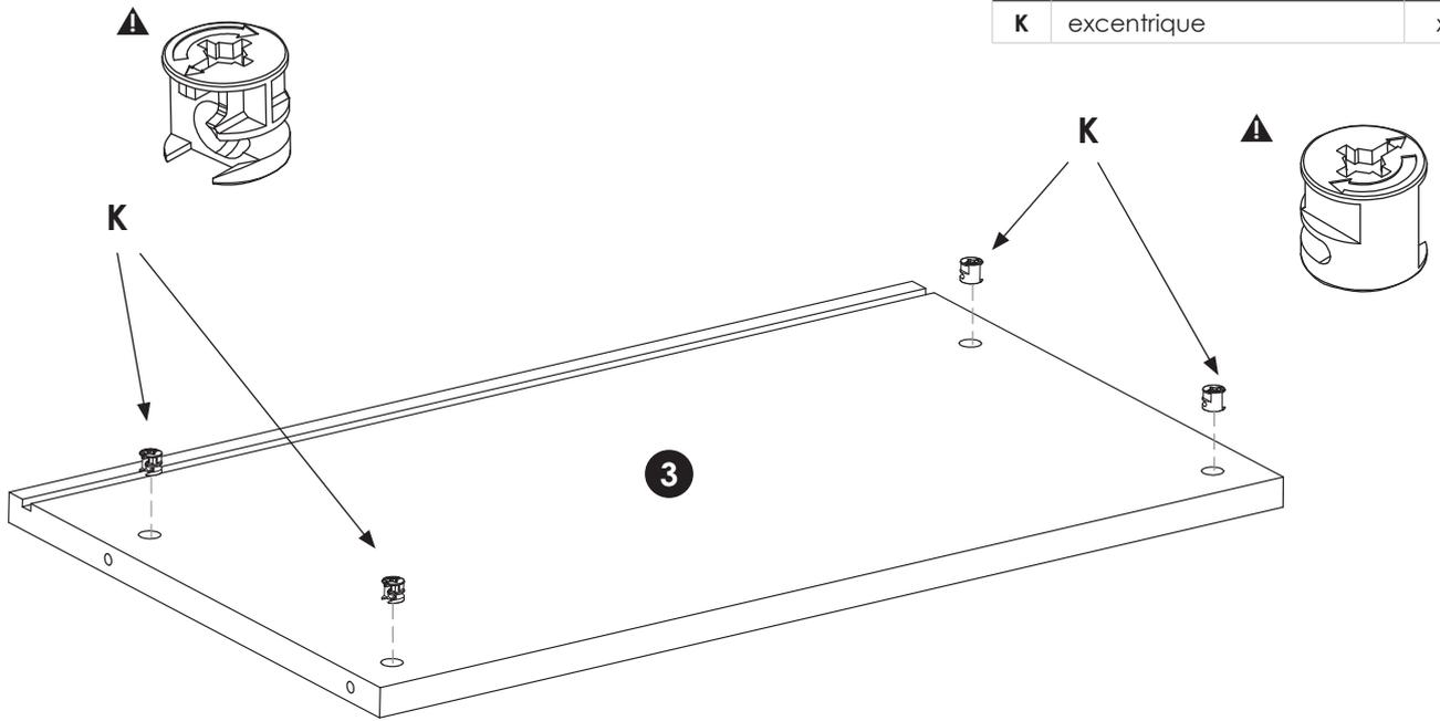
⚠ La flèche des excentriques est orientée vers l'extérieur de la tablette.
