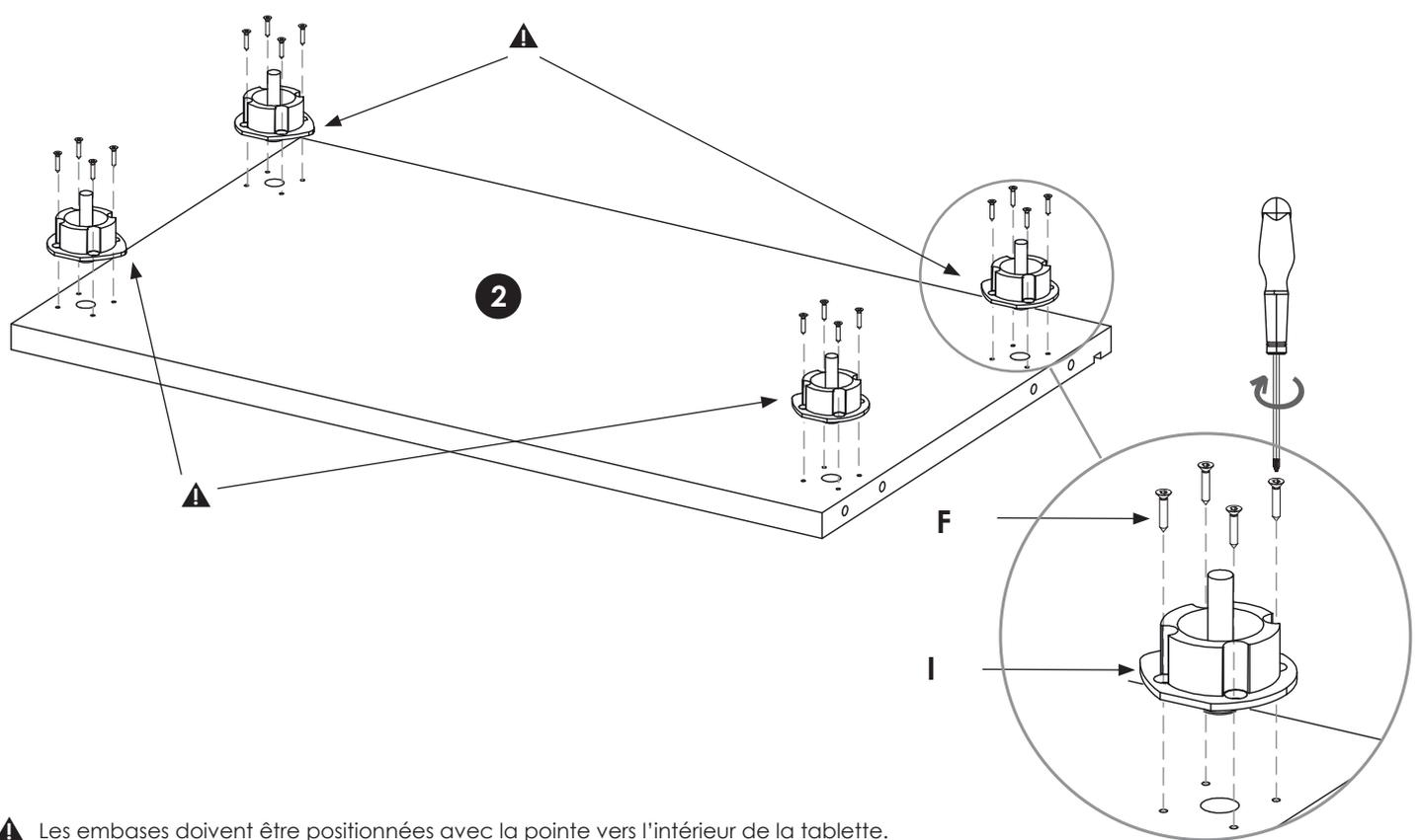
⚠ Les embases doivent être positionnées avec la pointe vers l'intérieur de la tablette.
